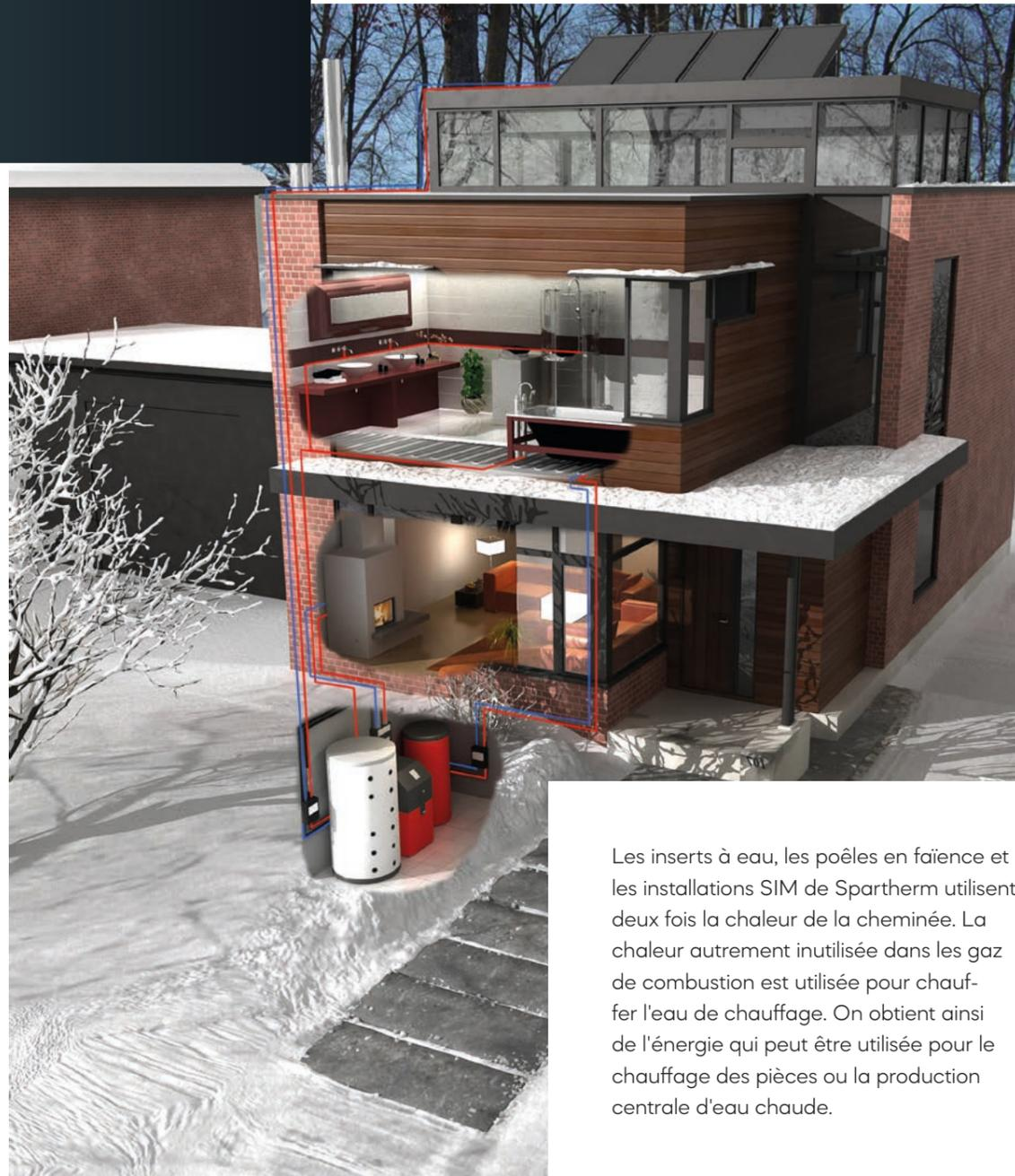
Les inserts à eau, les poêles en faïence et les installations SIM de Spartherm utilisent deux fois la chaleur de la cheminée. La chaleur autrement inutilisée dans les gaz de combustion est utilisée pour chauffer l'eau de chauffage. On obtient ainsi de l'énergie qui peut être utilisée pour le chauffage des pièces ou la production centrale d'eau chaude.
